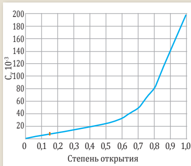
Рис. 1. Зависимость коэффициента C_V расхода шиберной задвижки от степени \xi ее открытия
